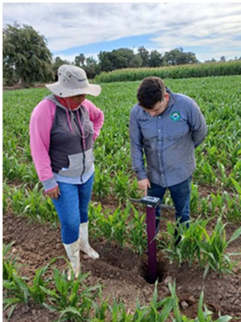
Figura 10. Medición del contenido de humedad con TDR
