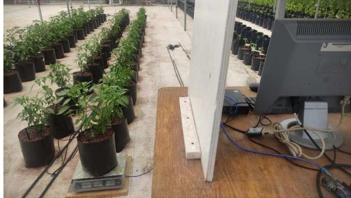
Figura 2. Instalación de la báscula en el invernadero, conectada a la computadora y al sistema de riego por goteo para chile Huacle en Tezontle.
