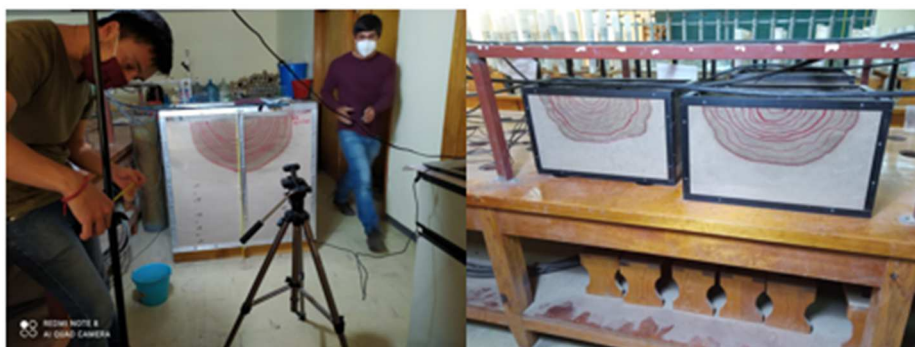
Figura 3. Mediciones de la geometría del bulbo húmedo en modelos físicos de paredes transparentes.
