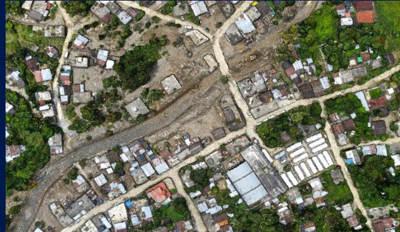
Restitución fotogramétrica con traslape frontal y lateral de 70 % a una altura de vuelo de 110 m
