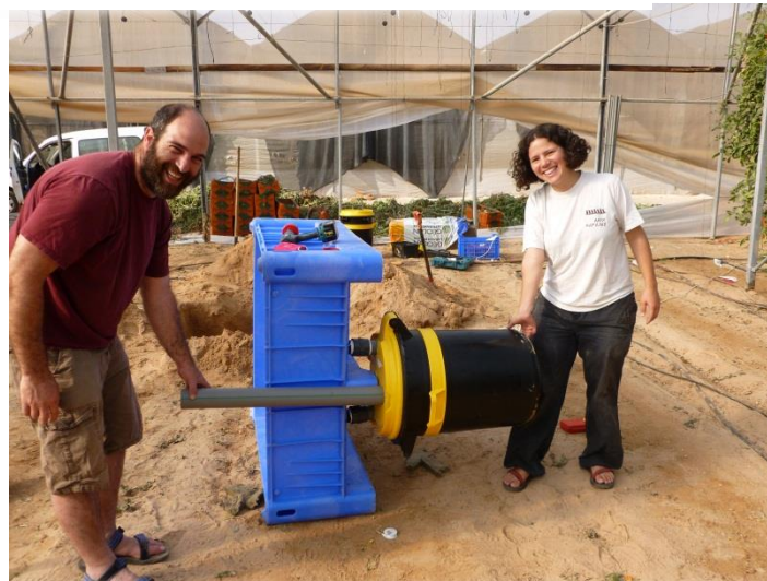
Lisímetro de drenaje
