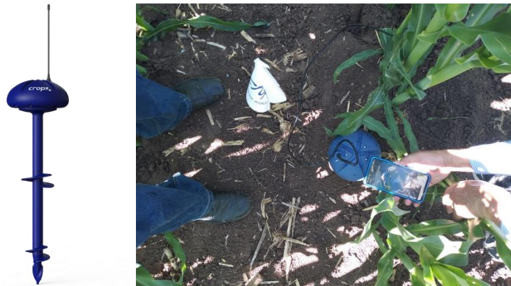
Figura 2. Sensor CropX (izquierda) e instalación de sensor en área de estudio (derecha)
