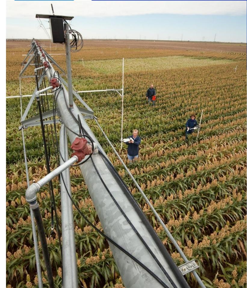
Instalación de sensores IRTs en la tubería lateral de un pivote central en Bushland, TX. Fuente: USDA-ARS
