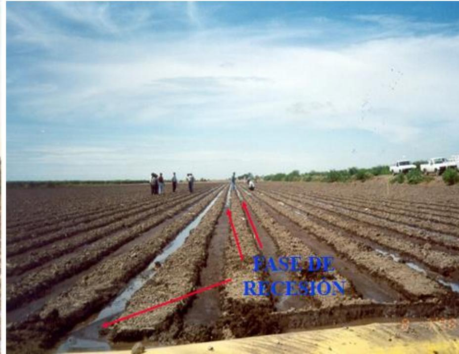
Determinación de los tiempos de avance y de recesión durante una prueba de riego por gravedad
