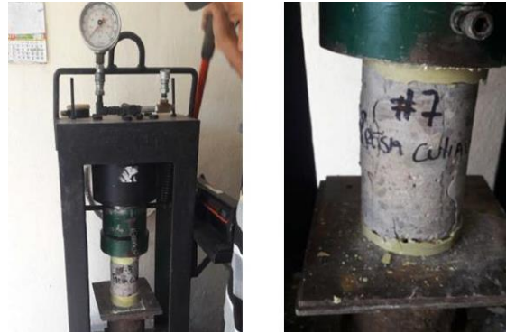
Figura 8. Momento de falla en núcleo de prueba No. 7
