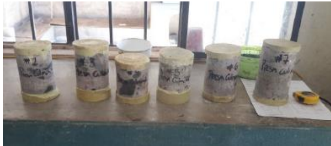
Figura 7. Núcleos de concreto cabeceado con azufre.
