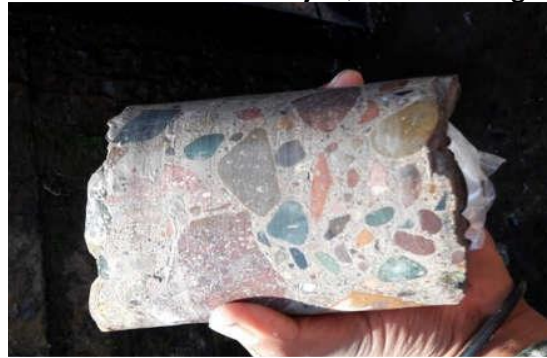
Figura 6. Muestra de la pantalla impermeable de la PDAW.
