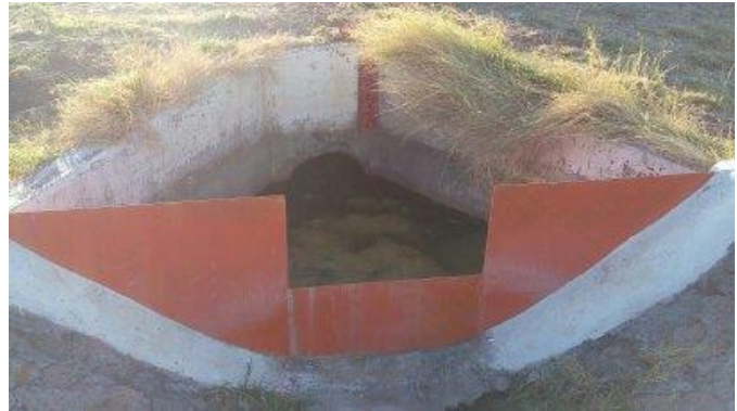
Figura 8. Vertedor rectangular cresta afilada
