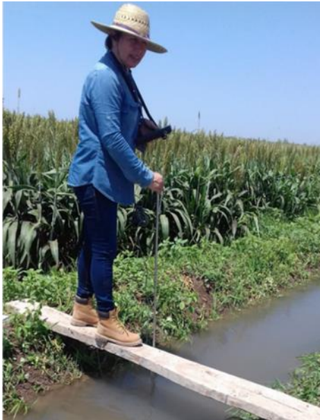
Figura 7. Medición de la velocidad del flujo
