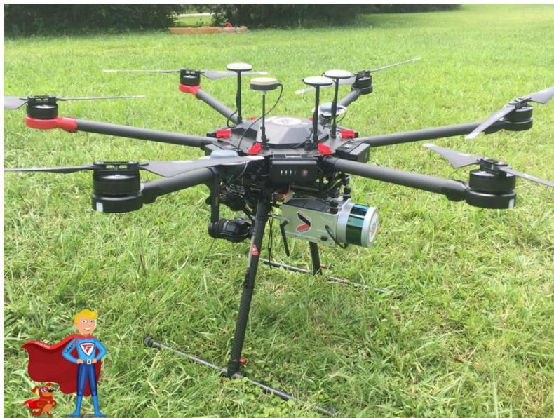
**Figura 7.** Sensor de LiDAR USA montado en un dron Hexacóptero
