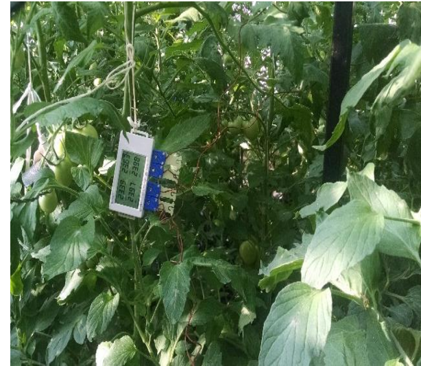
Figura 2. Instalación de los sensores infrarrojos y termopares Tipo T en el cultivo otoño-invierno
