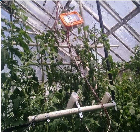
Figura 2. Instalación de los sensores infrarrojos y termopares Tipo T en el cultivo otoño-invierno
