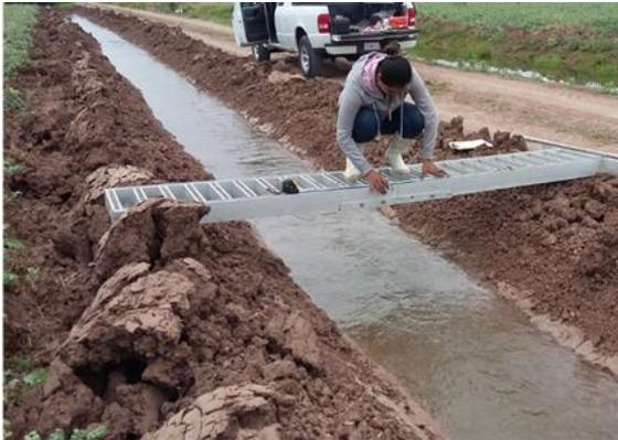
**Figura 1.** Medición del área, sección transversal regadera
