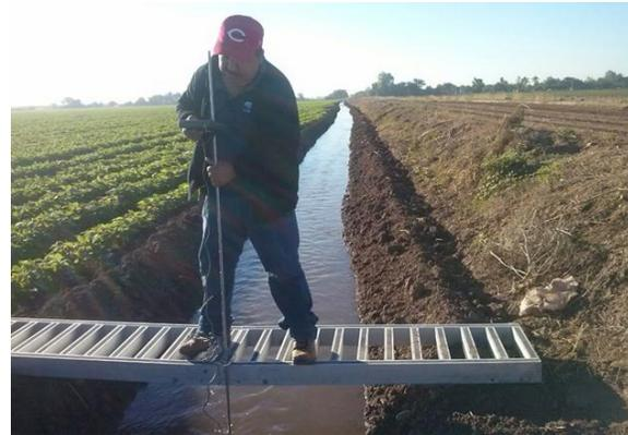
**Figura 2.** Medición de la velocidad mediante molinete electrónico
