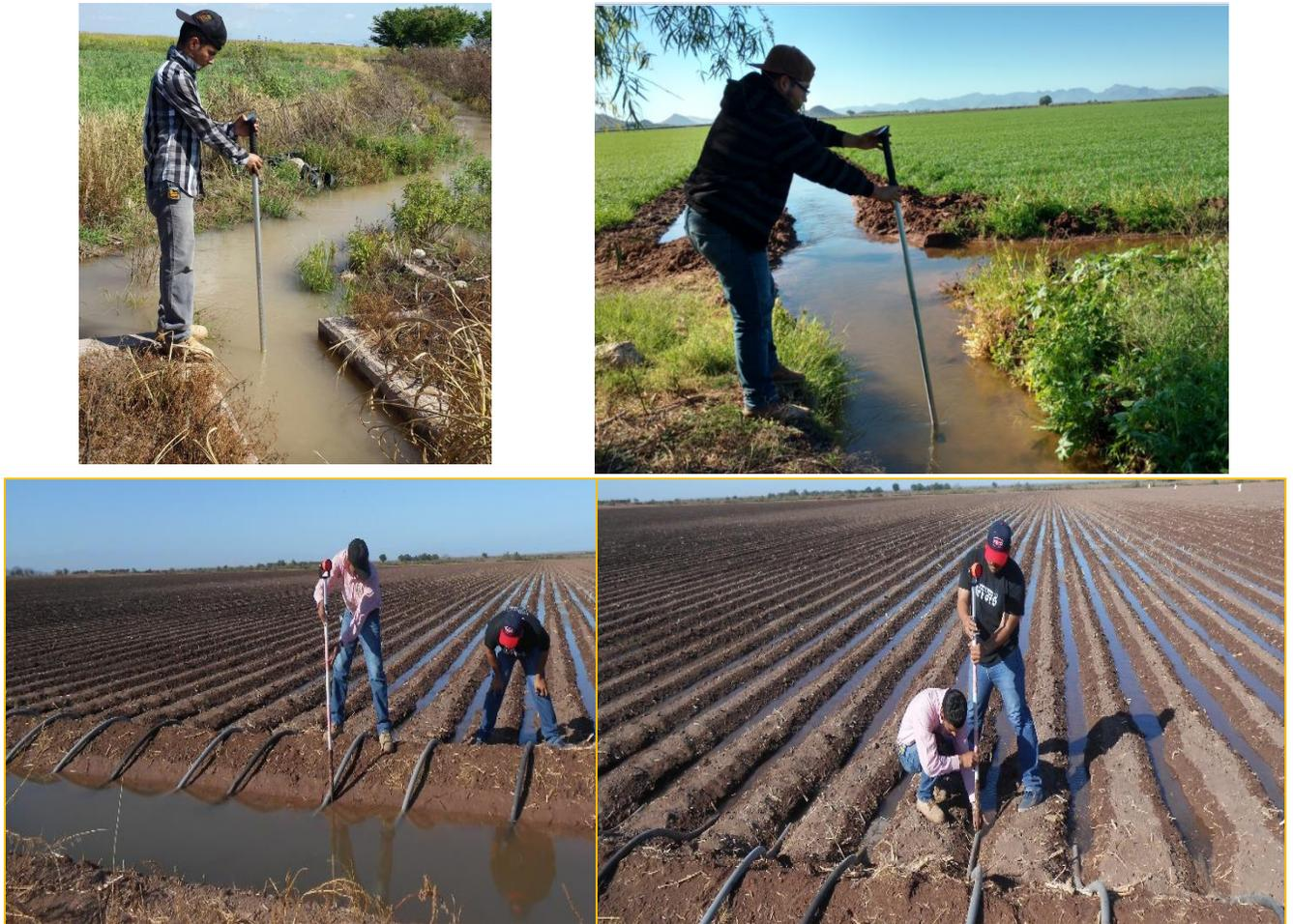
**Figura 7.** Medición de gastos con propela digital y sifones
