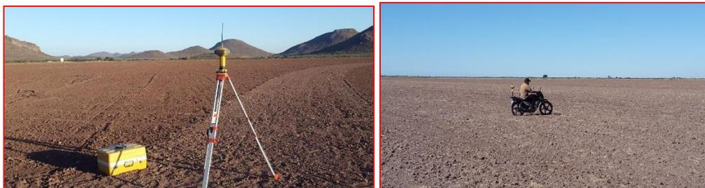
**Figura 9.** Topografía para nivelación con GPS diferencial.
