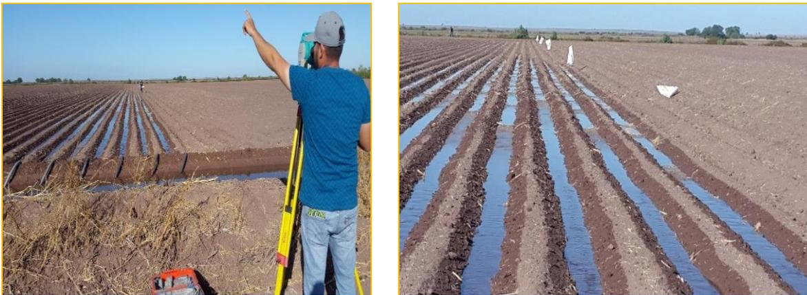
**Figura 9.** Colocación de estacas con estación total para prueba de riego y calibración
