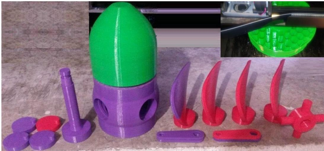
**Figura 4.** Componentes generados en PLA con 3-D, previo al tratamiento superficial. Relleno estructural hexagonal, de panal abeja.
