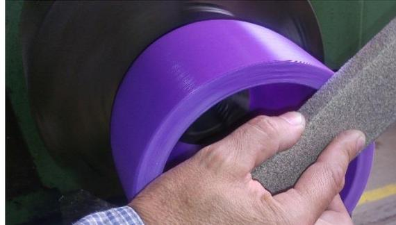
**Figura 5.** Rectificado en torno, con lija.
