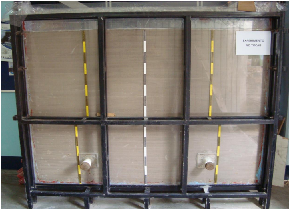
Figura 1. Foto tomada de la tesis de Chávez (2010). Módulo de drenaje utilizado para el experimento de infiltración.
