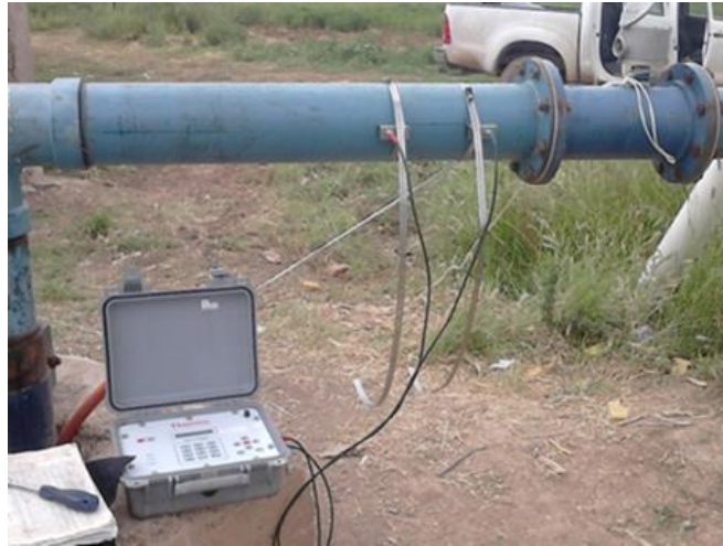
Figura 3. Uso del medidor de flujo ultrasónico
