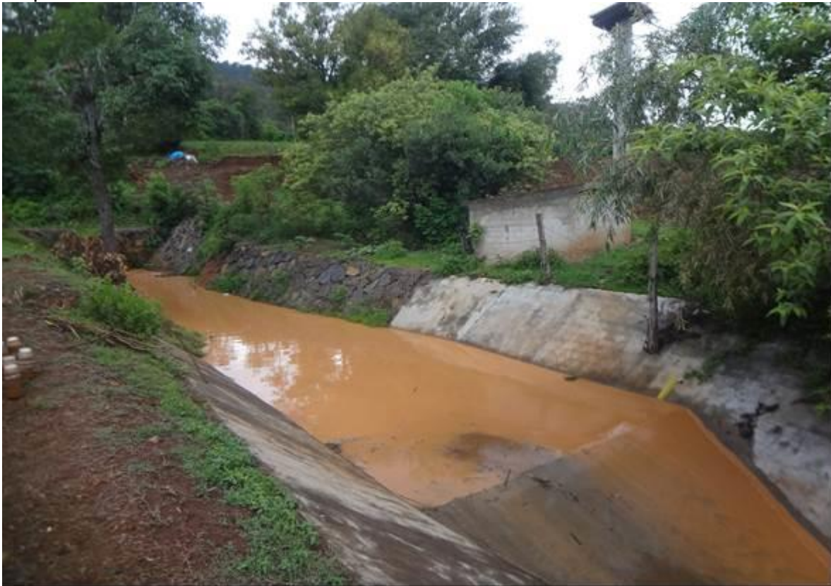
Figura 2. Aforador de garganta larga para medición de los escurrimientos en las microcuencas.
