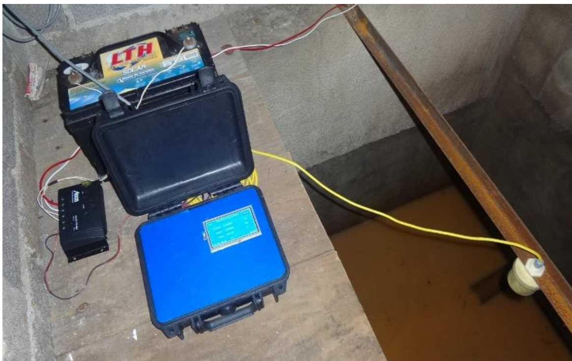
Figura 3. Medidor con sensor ultrasónico para el registro de los escurrimientos.
