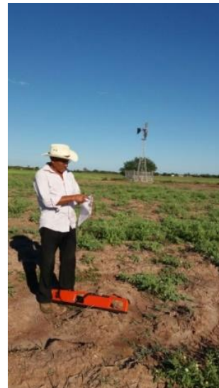
Figura 1. Monitorización de la salinidad con un sensor electromagnético EM-38 de Geonics Limited®.
