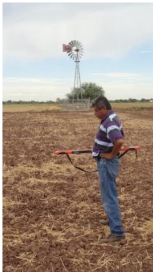
Figura 1. Monitorización de la salinidad con un sensor electromagnético EM-38 de Geonics Limited®.
