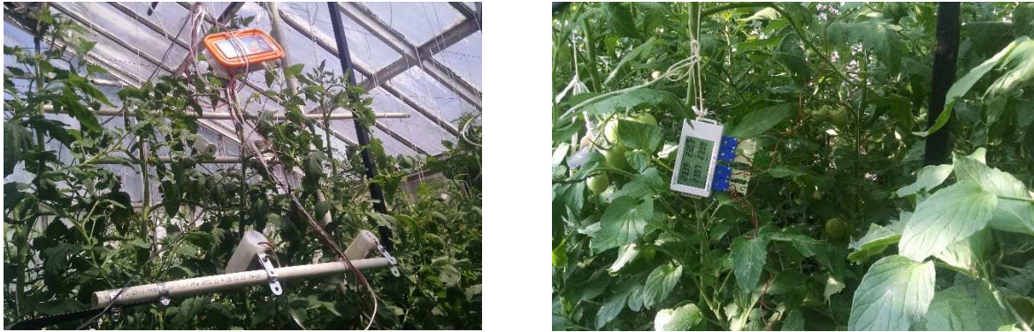
Figura 2. Instalación de los sensores infrarrojos y termopares Tipo T en el cultivo otoño-invierno.
