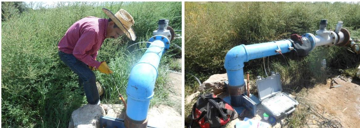
**Figura 2.** Obtención de datos en campo para el cálculo del índice energético. Medición del nivel estático y dinámico (izquierda); medición de flujo con medidor ultrasónico (derecha).
