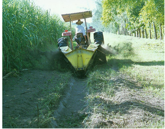
Figura 3. Drenaje superficial parcelario con zanjadora tipo Dondi
