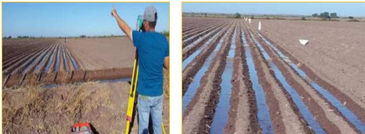
Figura 8. Colocación de estacas con estación total para prueba de riego y calibración
