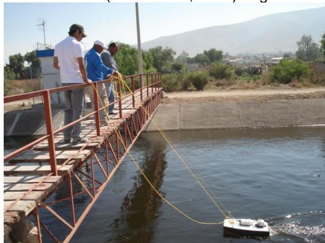
**Figura 4.** Aforo con perfilador Doppler
