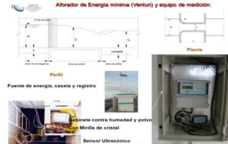
Figura 5. Modelo del aforador Venturi rectangular equipado
