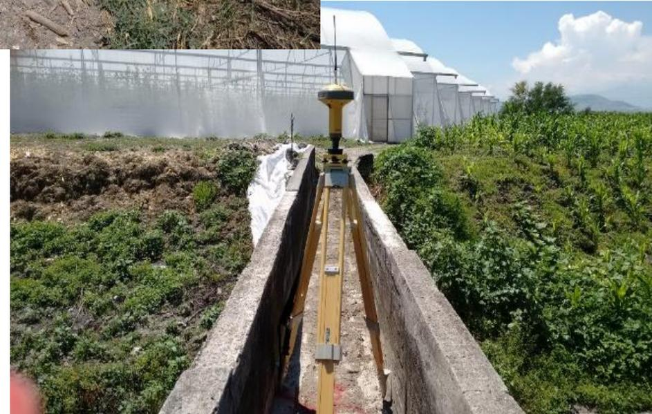
**Figura.** GPS RTK TopCon y marcas de puntos de control en la superficie
