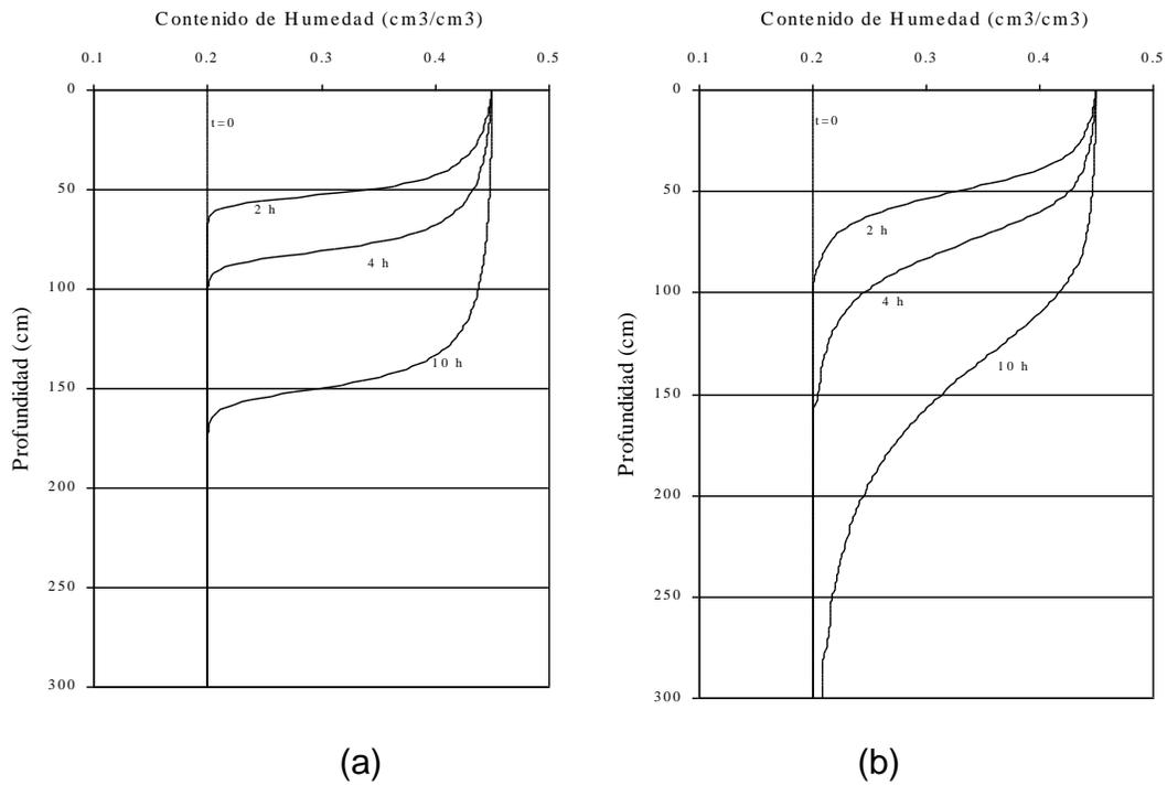
**Figura 1.** Simulación de la transferencia de agua. (a) Determinístico; (b) Estocástico.
