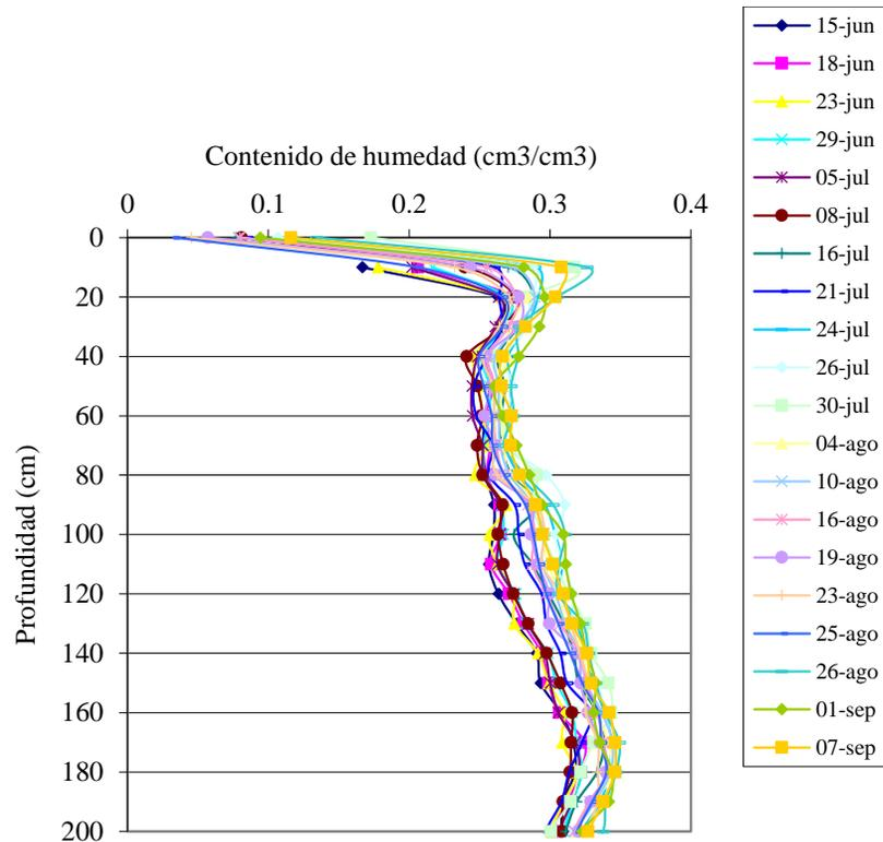
Figura 2. Ejemplo de perfiles medidos en sitio con suelo desnudo.
