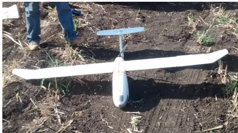
Figura 5. VAN modelo Skywalker, empleado en el levantamiento aerofotogramétrico.
