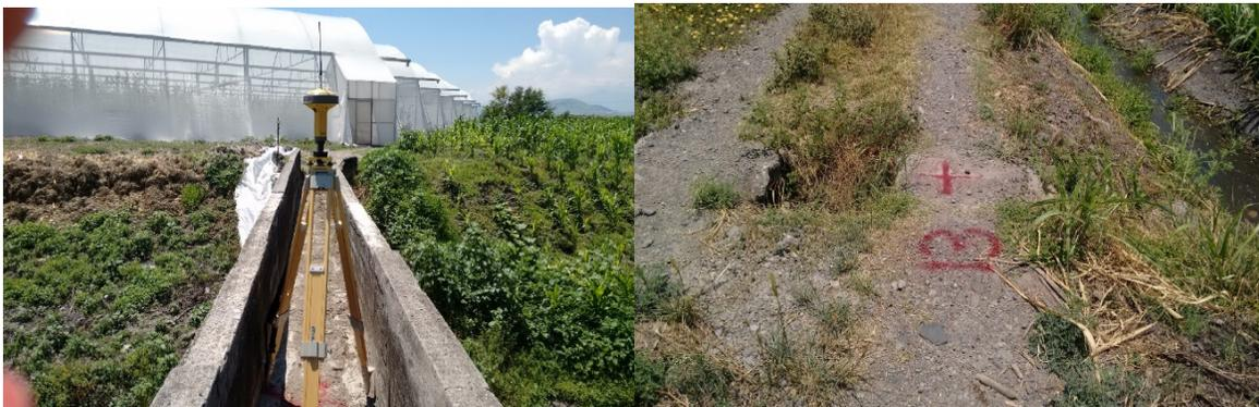
**Figura 5.** GPS RTK TopCon y marcas de puntos de control en la superficie
