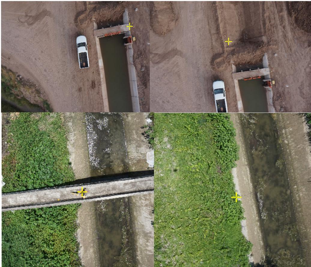
**Figura 6.** Puntos de control localizadas en las imágenes tomadas con el dron.
