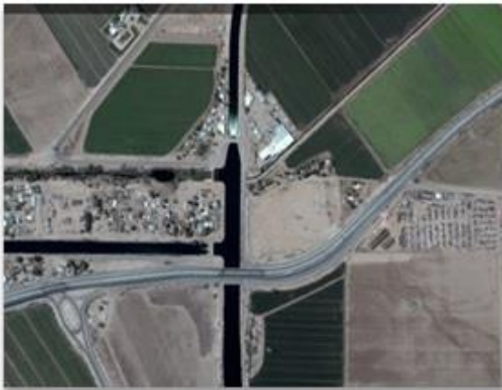
Figura 1. Ejemplos de bifurcación en el canal principal y un canal lateral en una red de riego. a) Y b) Distrito 014 Río Colorado Baja California.
