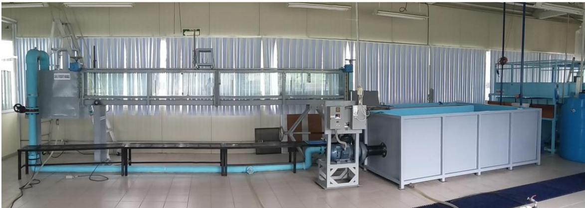
Figura 1. Canal experimental de pendiente variable.
