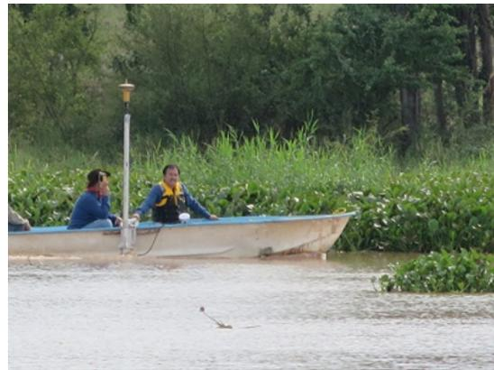
b) Equipo RTK instalado en la lancha
