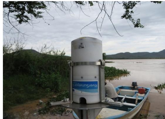
d) Equipo M9 de Sontek usado para medir profundidad
