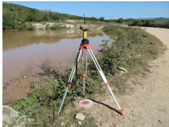
c) Estación base del equipo RTK
