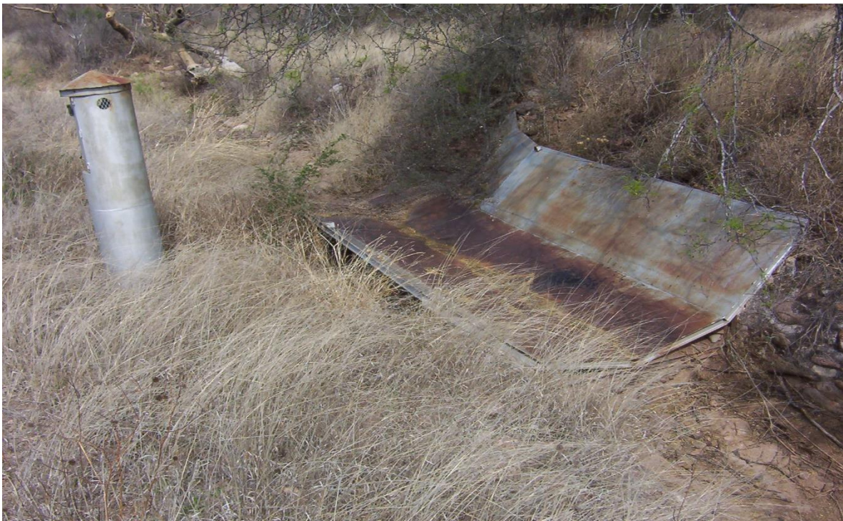
Figura 2. Estación de aforo con vertedor para flujo supercrítico tipo Santa Rita y limnógrafo FUESS en la cuenca La Cruz, Tabasco, Zac.
