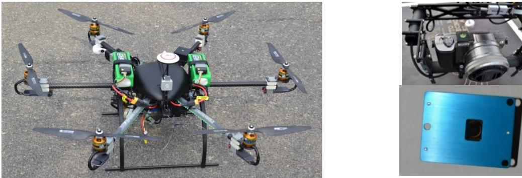
**Figura 7.** A bordo del UAV se instaló una cámara multisectorial TETRACAM mini MCA, dotada con tres Canales RGB.
