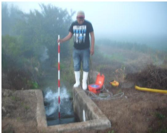
**Figura 5.** Medición con equipo ultrasónico.
