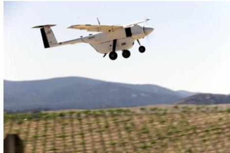
Figura 7. VANT en misión de monitoreo de un viñedo (Johnson et al., 2003).
