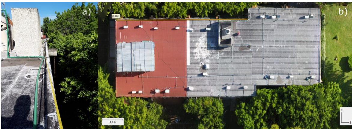
Figura 5. Ejemplo de comparación de longitudes: a) medición real y b) medición obtenida en el ortomosaico, mediante el VANT.
